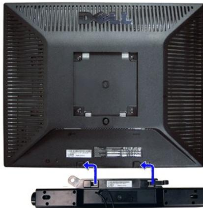
1. Von der Monitorrückseite aus befestigen Sie die Soundbar, indem Sie zunächst die beiden Schlitze mit den Zapfen an der unteren Monitorrückseite ausrichten.
