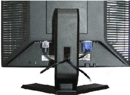
Verwenden Sie nach dem Anschließen aller erforderlichen Kabel an Ihren Monitor und den Computer (siehe [Anschließen des Monitors](#)) die Kabelführungsöffnung, um sämtliche Kabel wie oben abgebildet sauber zu verlegen.
